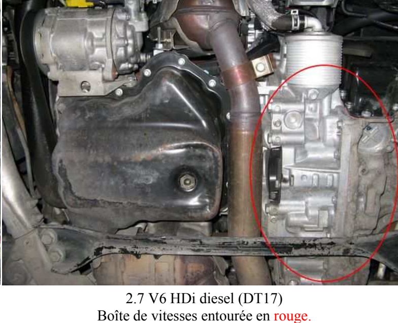
2.7 V6 HDi diesel (DT17) Boîte de vitesses entourée en rouge.
