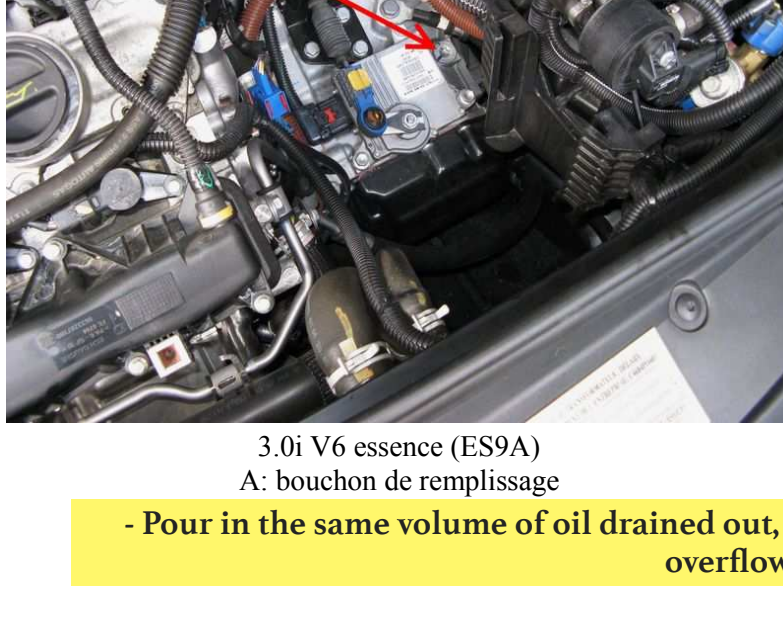
3.0i V6 essence (ES9A) A: bouchon de remplissage
