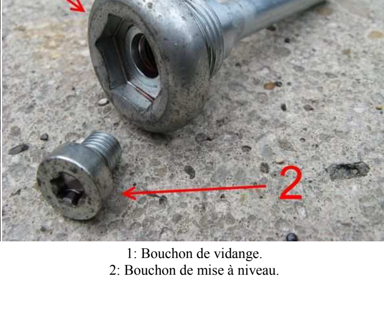
1: Bouchon de vidange. 2: Bouchon de mise à niveau.
