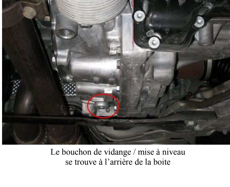
Le bouchon de vidange / mise à niveau se trouve à l'arrière de la boîte
