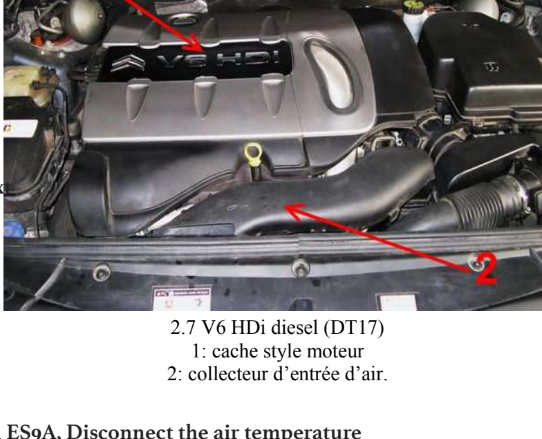
2.7 V6 HDi diesel (DT17) 1: cache style moteur 2: collecteur d'entrée d'air.
